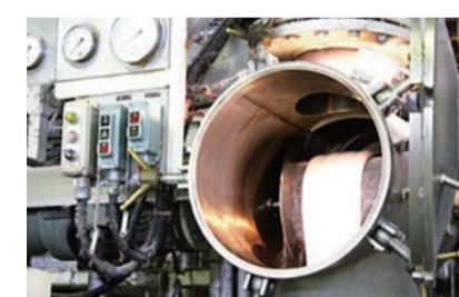
タオルの色落ちを防ぐため、糸の段階で行われる漂白工程に、今治の染色工場である大和染工が開発した新たな技術「オゾン漂白」を採用し、薬品の使用を30~50%削減。
